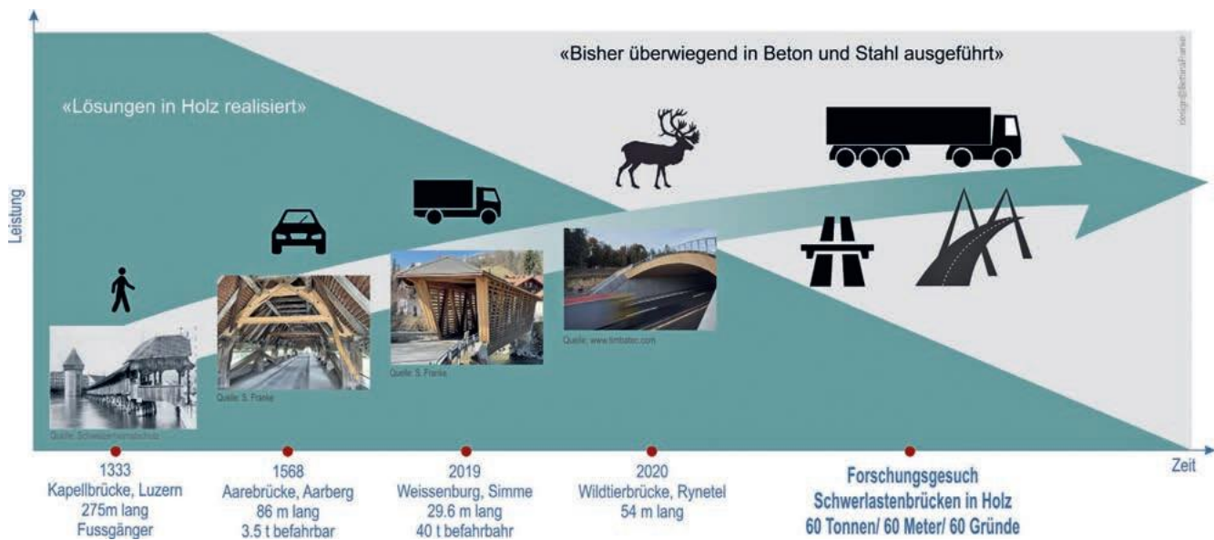
2 | Holzbrücken im Blick der Entwicklung, der grüne Bereich zeigt, wo Brückentragwerke in Holz erfolgreich realisiert werden, während der graue Bereich mit den Schwerlastbrücken im Nationalstrassennetz von den Werkstoffen Beton und Stahl beherrscht wird.
