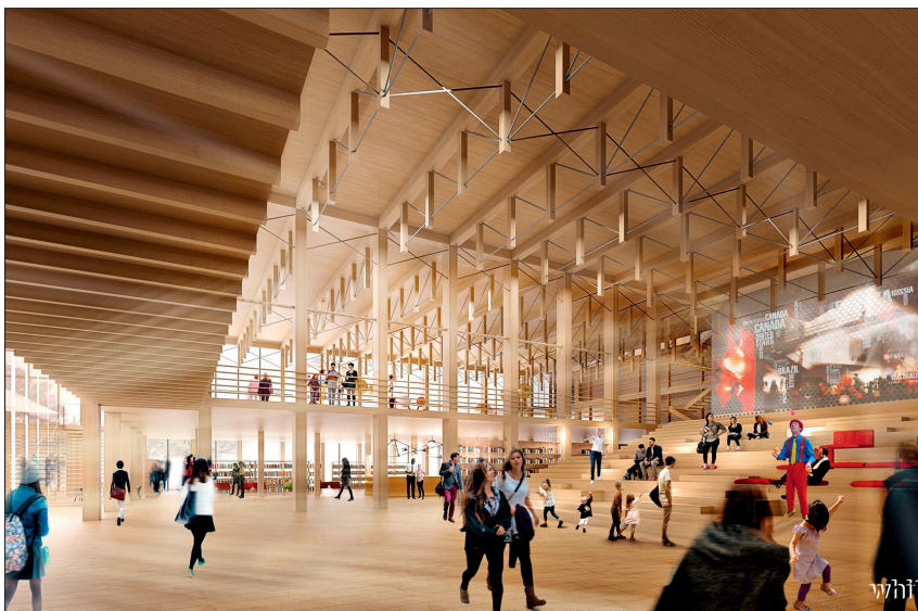
Die Decken im Bereich des Foyers des Kulturzentrums sind von weit spannenden kombinierten Holz-Stahl-Fachwerken überspannt. Wegen der großen Raumhöhe konnten die Brandschutzanforderungen an die Stahlbauteile wesentlich reduziert werden. Grafiken (2): White Arkitektur AB
